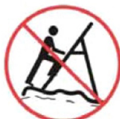
Postavenie rebríku na vodorovnom podklade
