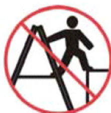
Presah rebríku nad miestom dotyku hornom stúpadle
