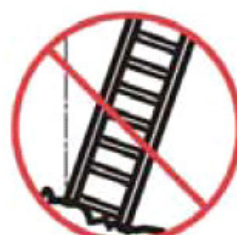
Postavenie rebríku na vodorovnom podklade
